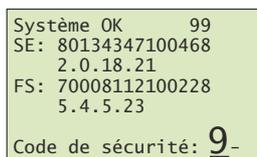
Entrez avec les touches et le 1er chiffre (gauche) du code de sécurité (le réglage d'usine est **9**).
