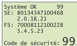
Entrez avec les touches et le 2ème chiffre (droit) du code de sécurité (le réglage d'usine est **9**).
