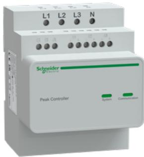
L'EVlink Home Peak Controller è un sistema di regolazione del carico elettrico che regola in continuo la potenza erogata al veicolo dalla stazione di ricarica in base alla potenza disponibile all'allacciamento dell'edificio.
