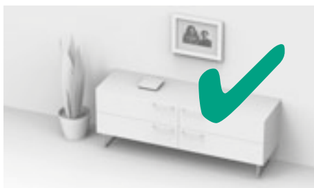
2 Posizionamento corretto del router nello spazio abitativo: non dentro, dietro o sotto un mobile.
