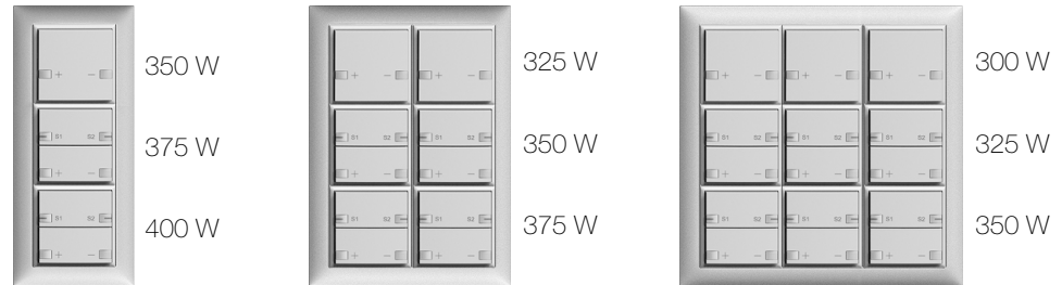
Fig. 26 Lasteinschränkung (maximale Last) in Kombinationen
