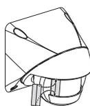
En cas de besoin, l'angle de détection peut encore être réduit par les réductions livrées.
