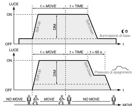
fig. 2 Illuminazione di base/ preavviso di spegnimento
