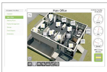
Fonctions de commande des éclairages, des stores et du chauffage
