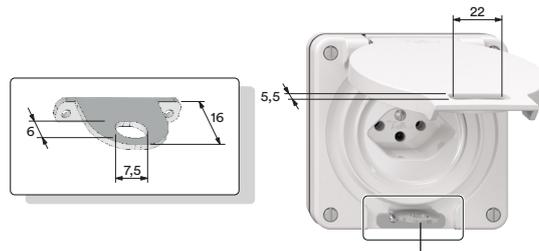
Je nach Montagelage, die Entwässerungsöffnungen rückseitig (Zentrierung vorhanden) mit 5mm aufbohren.
