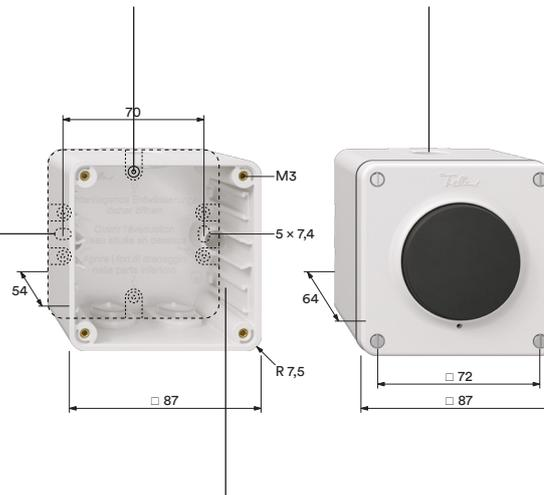
Bis zu vier Abzweigklemmen können montiert werden. Der grosse Anschlussraum bringt optimale Nutzungsmöglichkeit.
