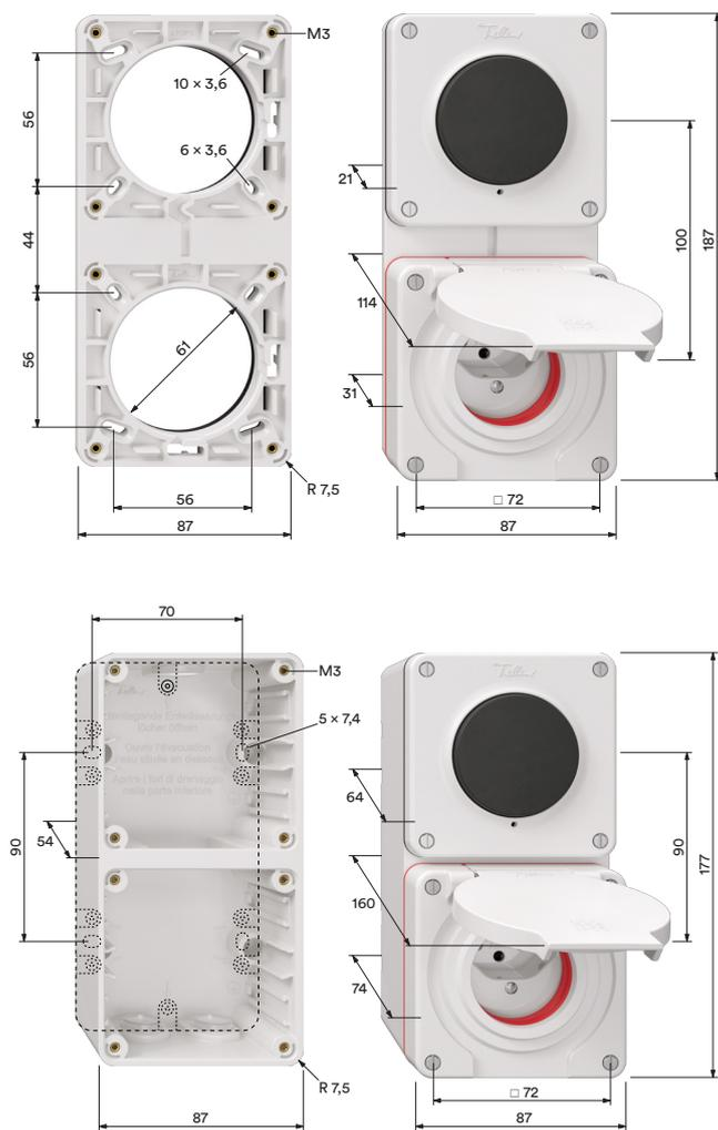
Bei vier oder mehr horizontalen Reihen werden 6 Befestigungslöcher benötigt
