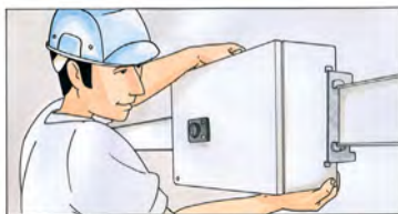
4. Installazione di una cassetta di derivazione
