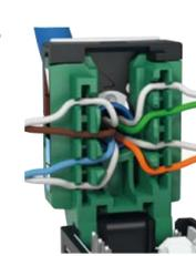
Die einzelnen Drähte in die Kabelvorrichtung einlegen und die Kabelenden auf die korrekte Länge zuschneiden.
