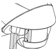
Con ogni foglio di copertura 44130.SET che viene fissato superiormente e inferiormente alla lente, si può ridurre il campo di rilevamento di 25° o di 12,5° (diminuendo il foglio lungo la perforazione). Il foglio di copertura è leggermente curvo. Prestare attenzione a posizionare la superficie liscia all'interno e la perforazione all'esterno.
