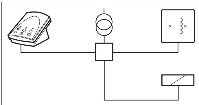
Eine Tischstation mit einer Türstation und Zusatzrelais
