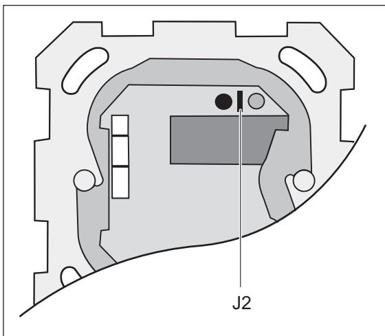
Der Wert der Temperaturabsenkung wird mit Hilfe der Steckbrücke (Jumper) J2 eingestellt:
