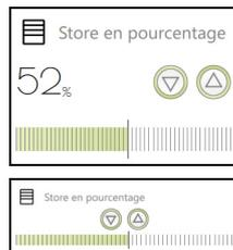
*Stores à lamelles* Un store à lamelles peut être monté et descendu ou déplacé dans une certaine position avec le curseur. L'orientation des lamelles peut également être réglée par curseur ou par commande pas-à-pas.
