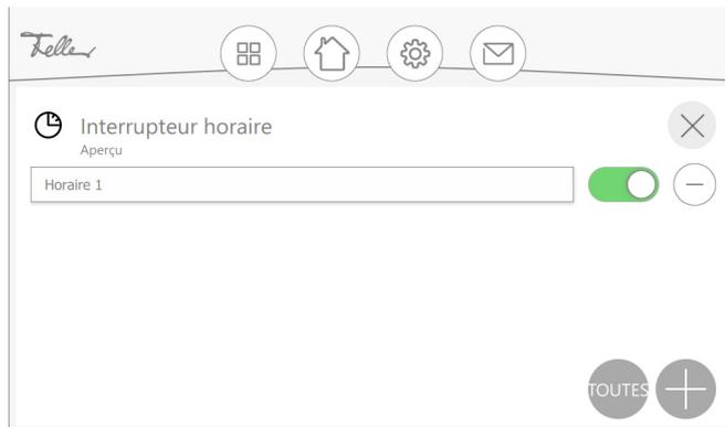
Avec le bouton à droite, vous pouvez désactiver l'interrupteur horaire (positionner le bouton à gauche) ou l'activer (positionner le bouton à droite). Par défaut, un nouveau interrupteur horaire est actif.
