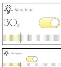
*Variateur RGB* Un luminaire RGB peut être enclenché ou déclenché et son luminosité peut être variée avec un curseur. Il est également possible de contrôler la couleur. Lorsque l'autorisation correspondante a été accordée, les réglages peuvent être sauvegardés en tant que \*) préreglage.
