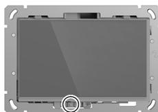
3. Tippen Sie auf **Neustart**. Das Home-Panel wird heruntergefahren und startet erneut wieder. Dadurch werden alle Anwendungen geschlossen, Speicher freigegeben und Dienste neu initialisiert.
