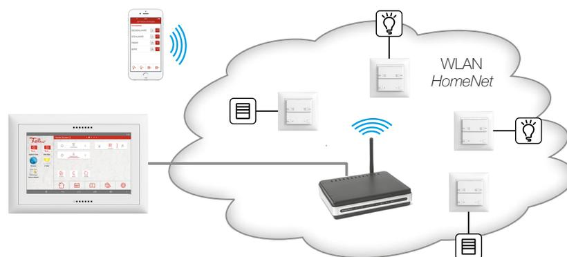
Während der Inbetriebnahme der zeprion WLAN-Geräte werden diese in Ihr WLAN-Heimnetzwerk eingebunden und mit der zeprion App konfiguriert. So macht die zeprion App Ihr Home-Panel zur Fernbedienung für alle Feller zeprion Licht- und Storenfunktionen.
