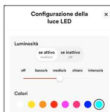
Tutti gli interruttori Wisier per luce e tapparelle sono illuminabili. Scegliere se i tasti devono illuminarsi nello stato commutato (**se attivo/controllo**), nello stato non commutato (**se inattivo/orientamento**) o in entrambi (permanente). Specificare il tipo e la luminosità dell'illuminazione, oltre al colore.
