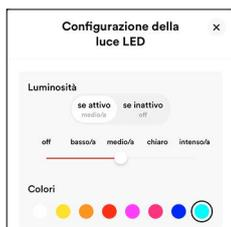
Tutti gli interruttori Wisery per luce e tapparelle sono illuminabili. Scegliere se i tasti devono illuminarsi nello stato commutato (*se attivo/controllo*), nello stato non commutato (*se inattivo/orientamento*) o in entrambi (*permanente*). Specificare il tipo e la luminosità dell'illuminazione, oltre al colore.
