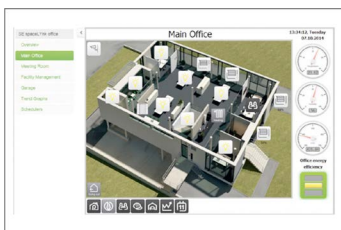
Funzioni per il controllo dell'illuminazione, delle tapparelle e del riscaldamento
