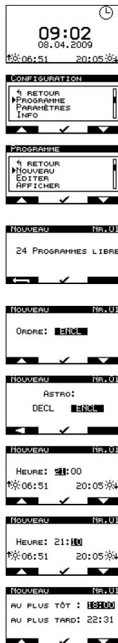
Appuyer sur la touche de sélection (5) pendant plus de 5 secondes. Le programmeur passe en mode configuration.
