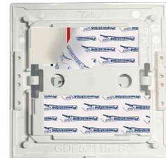
**i** Achten Sie auf die korrekte Ausrichtung des Apparats. Rückseite: Pfeil für oben; Vorderseite: Markierung "0" des Funkmoduls oben.
