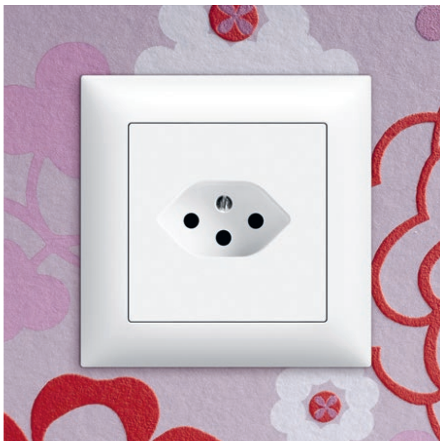
1fach Steckdose Typ 12 (wird Ende 2016 gemäss NIN 2015 vom Typ 13 abgelöst)
