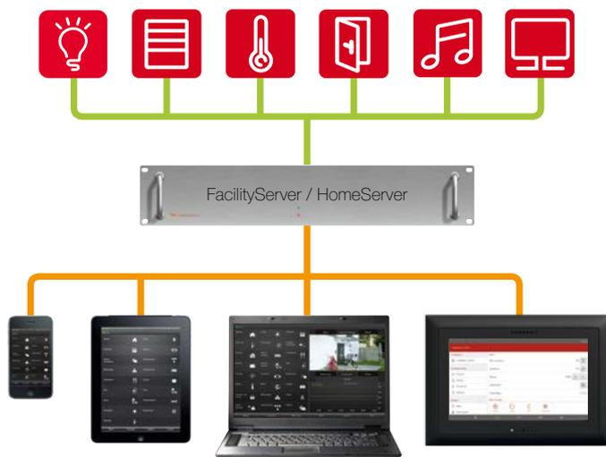
Toute la technique de bâtiment KNX peut aussi être commandée confortablement par un iPhone, un iPod touch ou un iPad via l'app d'interface de Feller SA. L'interface affiche clairement toutes les fonctions et permet un accès mobile à la technique de bâtiment.
