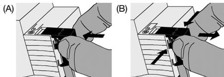
Dopo aver collegato la linea bus: per proteggere il collegamento a bus da pericolose tensioni nell'area di connessione, inserire il cappuccio (A):
