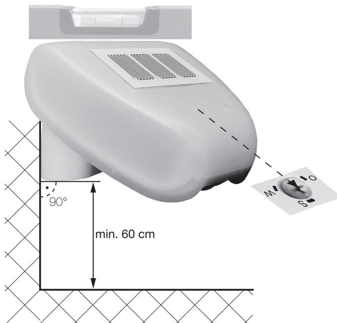
Fig. 10 Ausrichtung Multisensor
